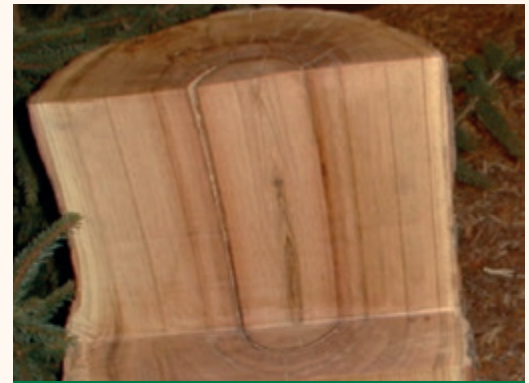
Abb. 3: Längsschnitt Holz Edelkastanie, Foto: wikimedia
